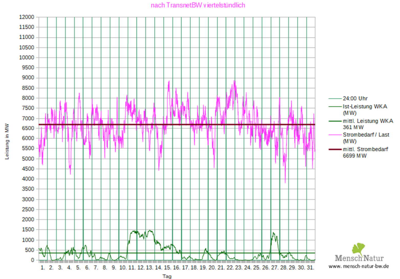
Leistungsverlauf Windleistung gegen Strombedarf (Last) TransnetBW
